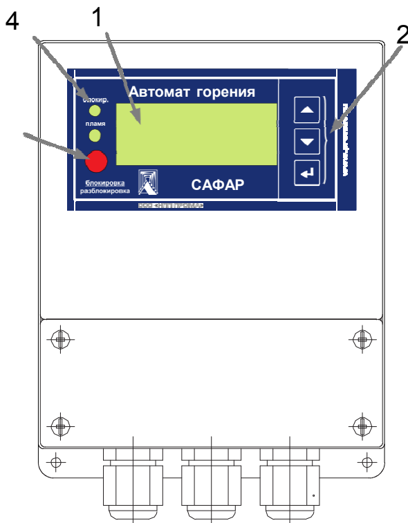
Рис. 3: Лицевая панель автомата горения САФАР настенного исполнения. 1 – ЖКИ; 2 – кнопки управления; 3 – кнопка блокировки; 4 – светодиоды.
