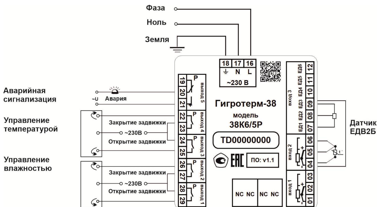
Схема 1. Регулирование влажности и температуры с использованием электроздвижек. Для измерения влажности и температуры применяется датчик ЕДВ25
