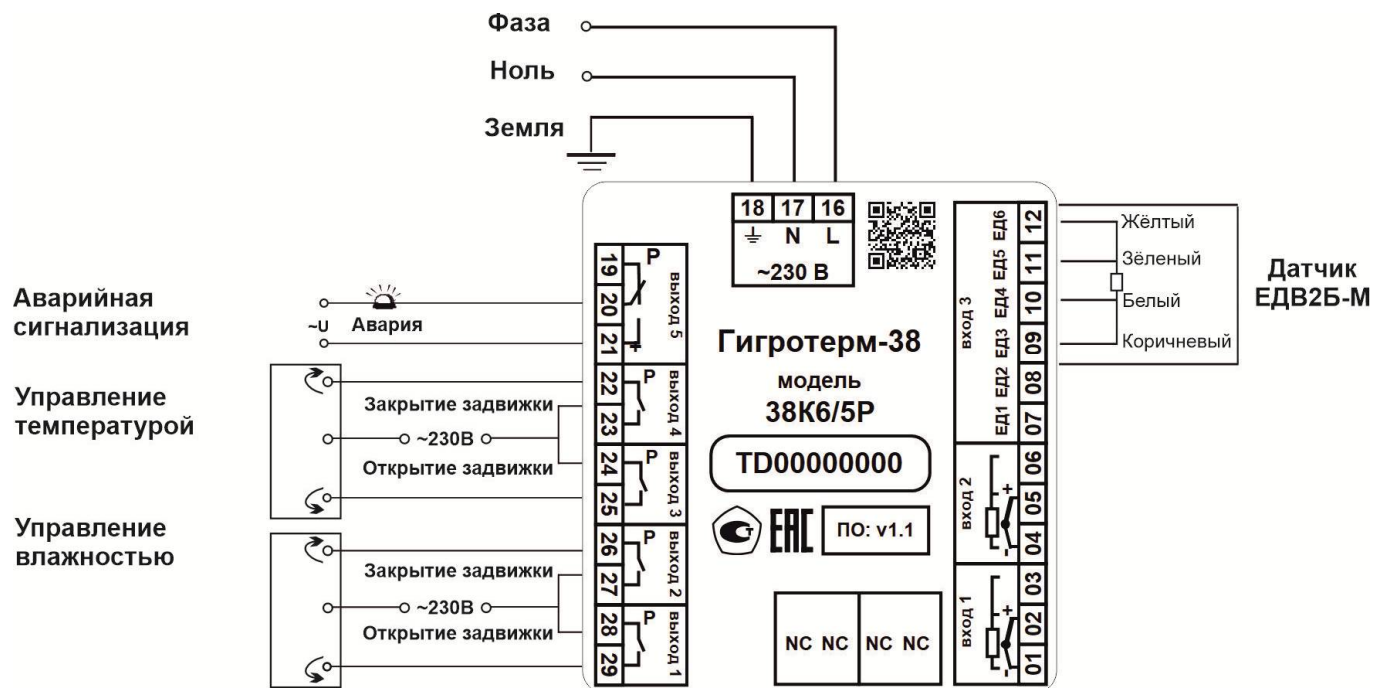
Схема 3. Регулирование влажности и температуры с использованием электрозадвижек. Для измерения влажности и температуры применяется датчик ЕДВ2Б-М
