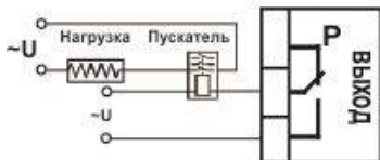
Подключение нагрузки мощностью более 2,3 кВт с помощью электромагнитного пускателя
